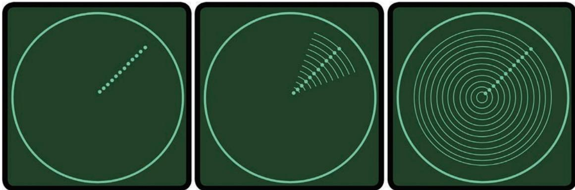
Figura 6. Señales SART visualizadas en un radar banda X a diferentes distancias
