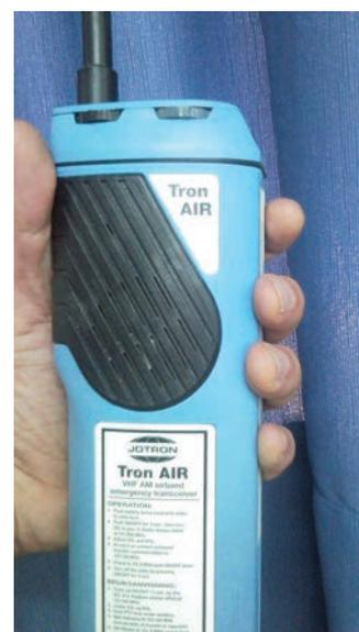
Figura 4. Portátil SAR de Banda Aeronáutica de 121,5 MHz
