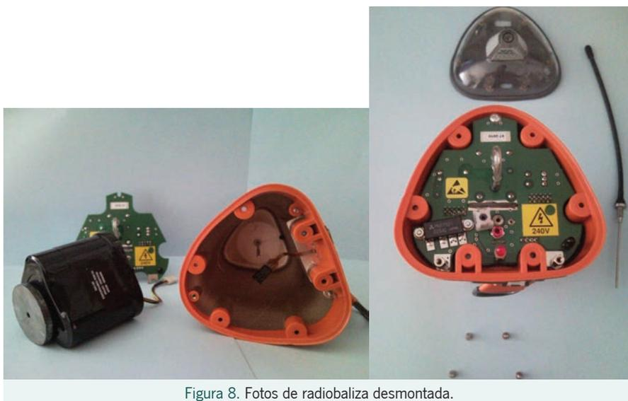
Figura 8. Fotos de radiobaliza desmontada.
