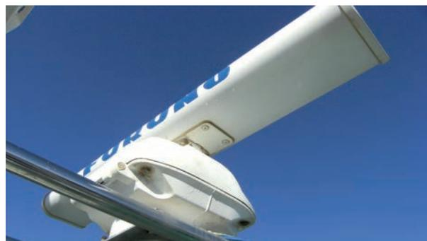
Figura 3. Antena radar banda X
