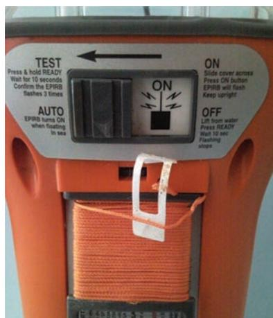
Figura 3. EPIRB sin precinto y preparada para su activación
