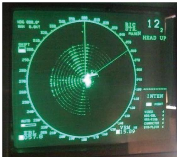
Figura 7. SART detectado en pantalla radar
