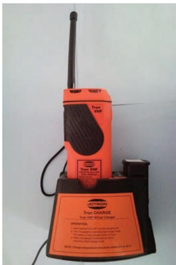
Figura 2. Cargador portátil GMDSS de VHF
