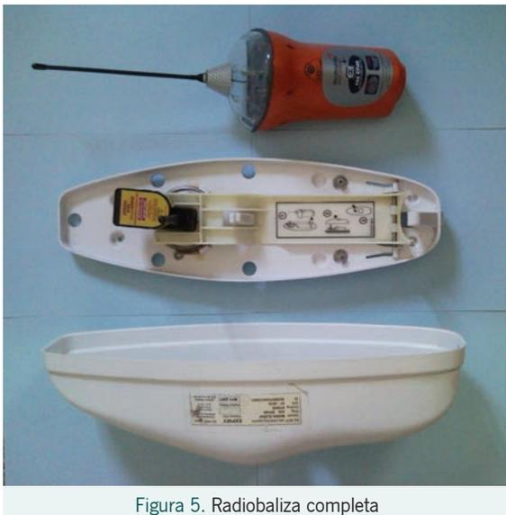
Figura 5. Radiobaliza completa
